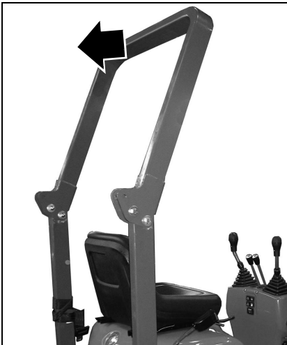
Fig. 83: Abaisser l'arceau de sécurité
