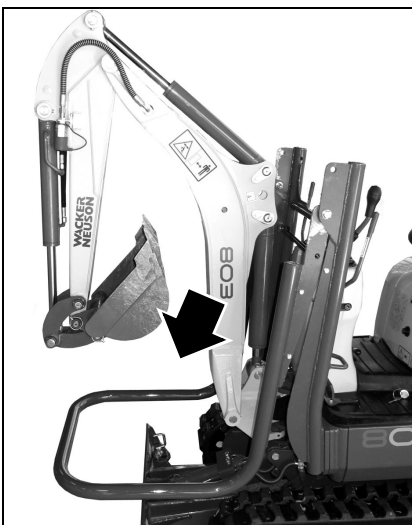
Fig. 87: Arceau de sécurité abaissé
