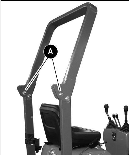
Fig. 82: Abaisser l'arceau de sécurité
