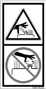
Fig. 26: Le réservoir est sous pression
