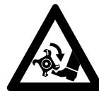
Wird der Motor in Stellung "Start" angeworfen, werden direkt nach dem Anspringen die Arbeitswerkzeuge angetrieben. Beim Starten immer seitlich vom Gerät stehen – nie vorne im Bereich der Arbeitswerkzeuge. Durch Kontakt mit den Arbeitswerkzeugen – **Verletzungsgefahr!**
