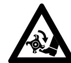
De handen en de voeten weghouden van het werktuig. Nooit een roterend werktuig aanraken – **kans op letsel!** Tijdens de werkzaamheden altijd achter de beschermkap of opzij van het apparaat staan – nooit aan de voorzijde, in het bereik van de werktuigen.
