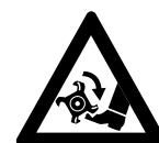
Hände und Füße vom Arbeitswerkzeug entfernt halten. Niemals ein rotierendes Arbeitswerkzeug berühren – **Verletzungsgefahr!** Während der Arbeit immer hinter dem Schutz oder seitlich vom Gerät stehen – nie vorne im Bereich der Arbeitswerkzeuge.
