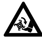
Als de motor in stand "Start" wordt gestart, worden de werktuigen direct na het aanslaan van de motor aangedreven. Bij het starten altijd aan de zijkant van het apparaat staan – nooit voor het apparaat binnen het bereik van de werktuigen. Door contact met de werktuigen – **kans op letsel!**
